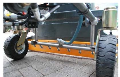
Wenn der Ölspur-beseitiger außer gebrauch ist wird den Saugschlauch auf der Hinter Klappe abgelegt.
