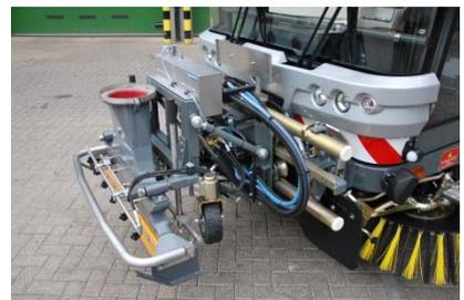
Sowohl das Standard Saugrohr wie auch der Sinkkasten-Saugarm sind ausgestattet mit einer Hydraulisch-Schließbaren Klappe die mittels einem Schalter am Armaturenbrett bedient wird.
