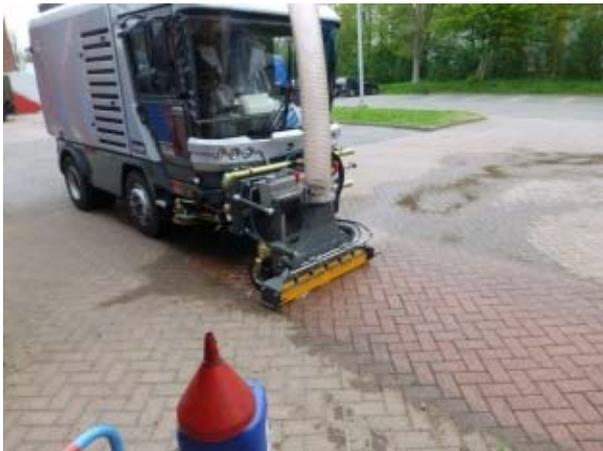
Der RAVO-Ölspur-Beseitiger kann statt des 3. Besens direkt auf das Schnellwechselsystem an der RAVO 5ER-Serie gekoppelt werden.
