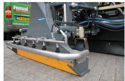
Der 1.100 mm. breite Frontsauger ist auf einem Rahmen mit Seiten-Verstellung montiert. Dieser Rahmen passt auf das Schnellwechselsystem was auch benützt wird für den 3. Besen oder die Walzenbürste.
